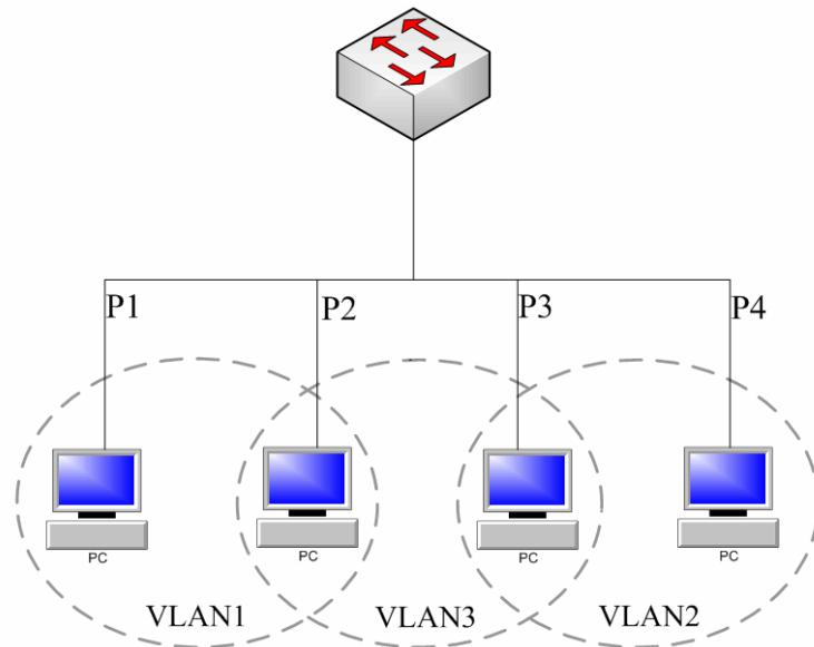
图 5-1 Port VLAN 示意图
