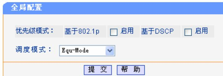
图 5-27 端口优先级配置
