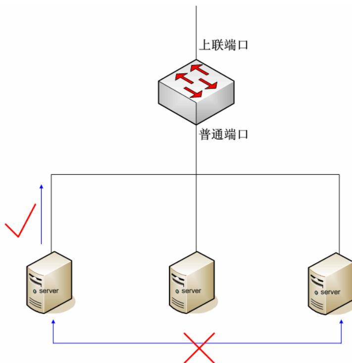
图 5-4 MTU VLAN 示意图
