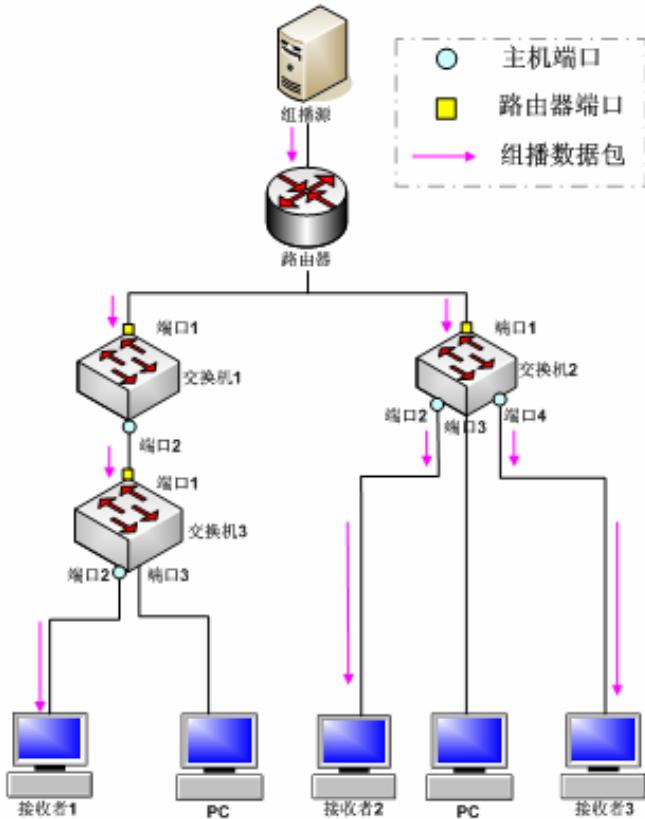
图 5-20 IGMP Snooping 相关端口
