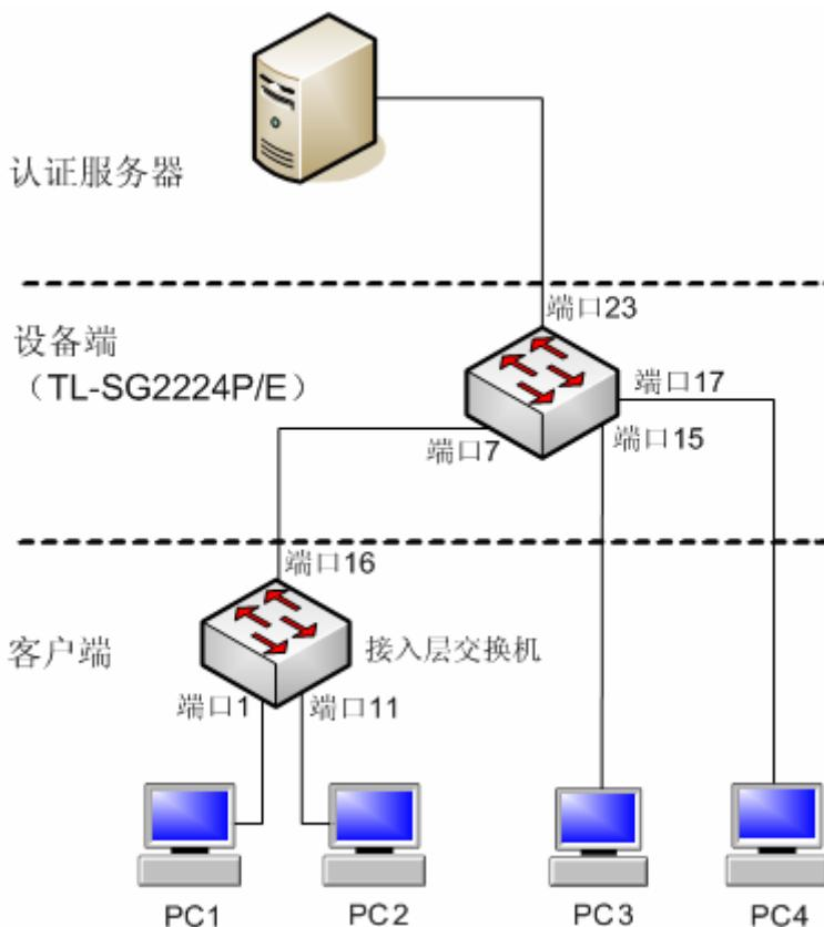
图 5-31 802.1X 系统的典型体系结构
