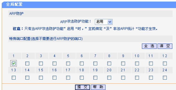
开启 ARP 攻击防护功能，将端口 1 选择为不需要进行 ARP 防护的端口，点击提交。
