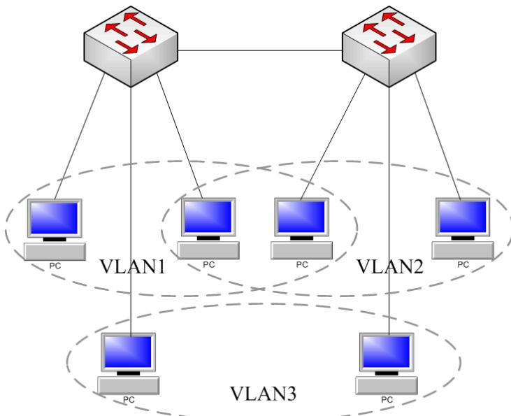
图 5-2 Tag VLAN 组网示意图
